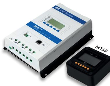
Los reguladores solares MPPT (Maximum-Power-Point-Tracking) son necesarios como enlace entre los paneles solares y las baterías. Con la tecnología MPP, el regulador determina automáticamente la potencia máxima de los paneles solares en todo momento. Esto reduce el tiempo de carga de la batería, se reduce significativamente en comparación con los cargadores solares convencionales. Los reguladores solares MPPT funcionan de forma totalmente automática,
